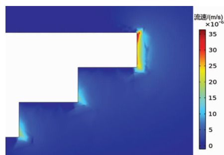
图6 三台阶法开挖100 h后瓦斯流速云图
