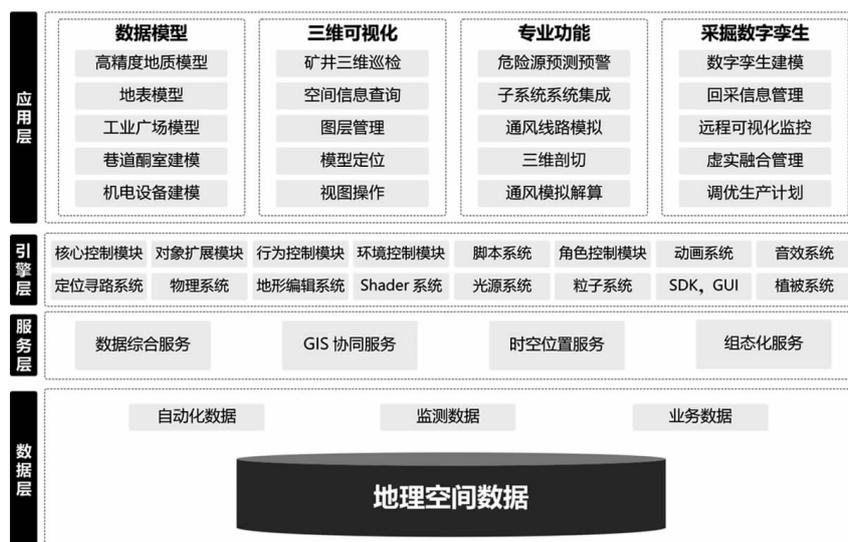
图 1 三维透明矿山系统架构
