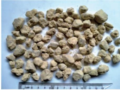
图 5 泥化粗粒土 10~20 mm 颗粒形状
