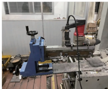
图5 可旋转移动钻机和钻头
