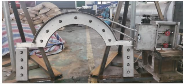
图9 外喷雾装置的加工与测试
