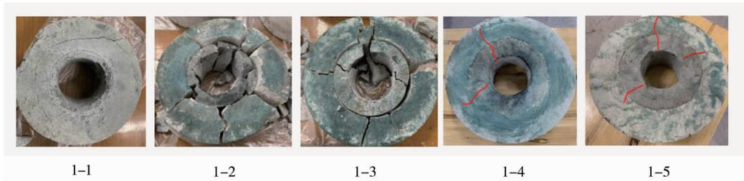
图11 第一组试件破坏形式
