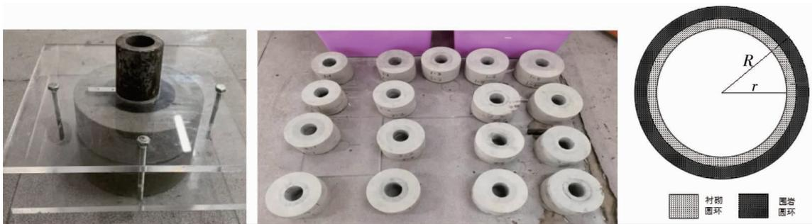
图 1 围岩与初支结合体试验试样
