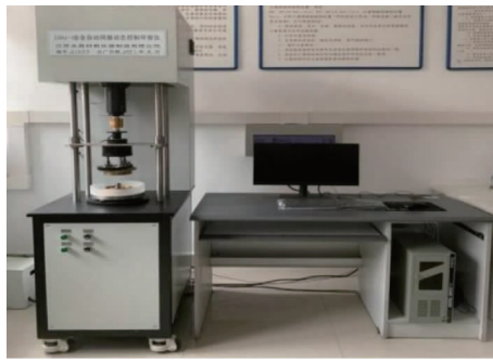
图2 ZSHJ-3型全自动伺服动态控制环剪仪
