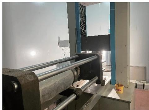
图2 三轴岩石剪切流变试验仪
