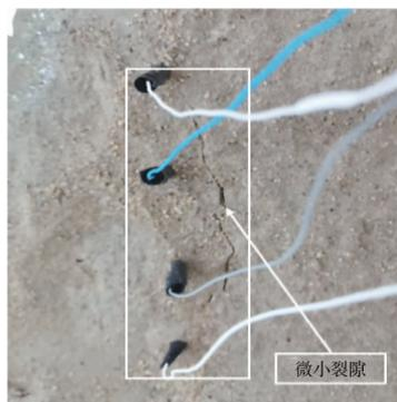
图 5 边坡表面产生的微小裂隙
