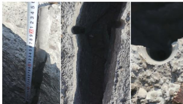
图9 有聚能穴有金属罩装药结构爆破效果
