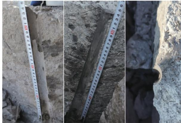
图8 有聚能穴无金属罩装药结构爆破效果
