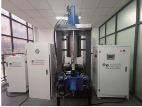
图2 多物理场耦合岩石力学试验机
