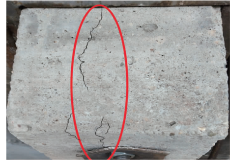
图7 预应力为12MPa时试件的破坏状态
