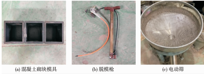
图3 预制混凝土砌块制作工具
