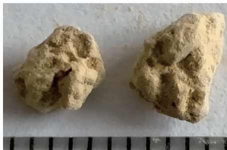
图3 粒径为2~5 mm的颗粒表面泥化形态(标尺间距为1 mm)
