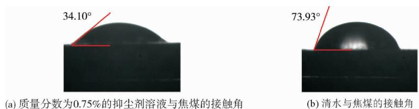
图 5 接触角实测效果
