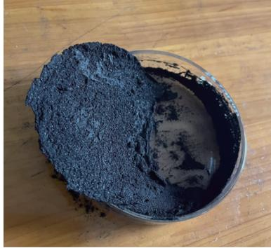
图6 抑尘剂溶液与煤粉干燥后的黏结层
