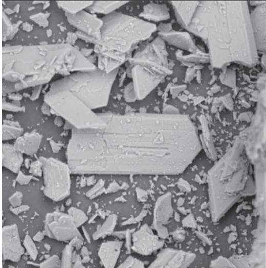
图1 磷石膏原样扫描电镜图像
