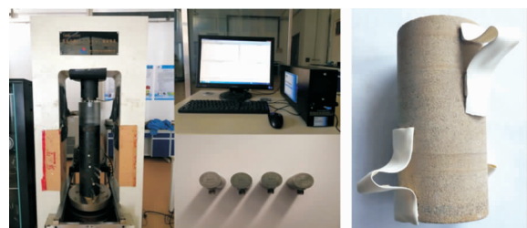
图 4 加载系统、声发射监测系统及处理好的岩样
