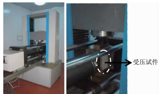
图2 RYL-600 岩石剪切流变仪及加载方式
