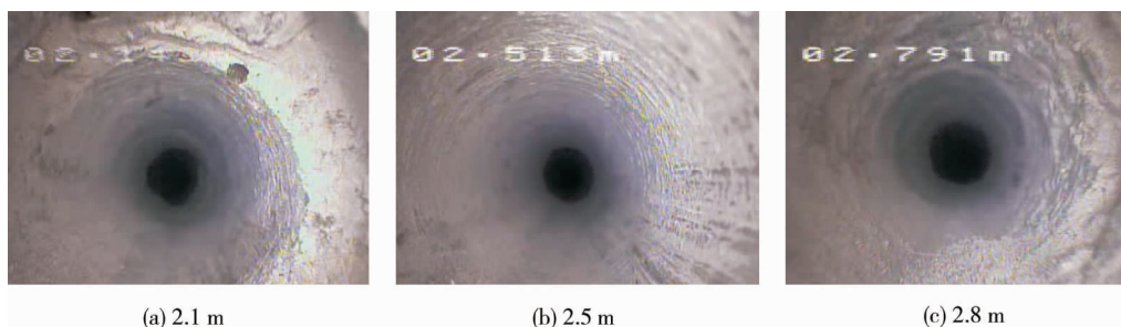
图13 南回帮部窥镜测试典型图像(起始位置为0.081 m)
