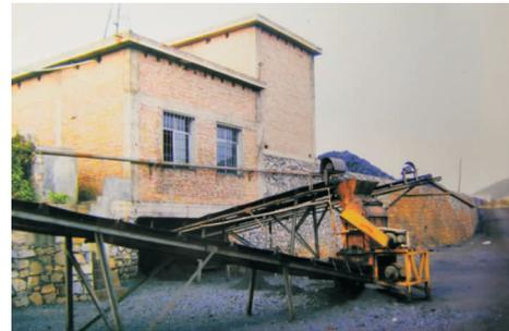
图5 斜式物料输送机和 120  $\text{m}^2$  建筑物
