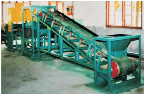
图4 倾斜式物料输送机和接地探测器屏蔽室
