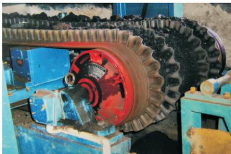
图6  $^{241}\text{Am}$  接地源容器与双通道送料胶带
