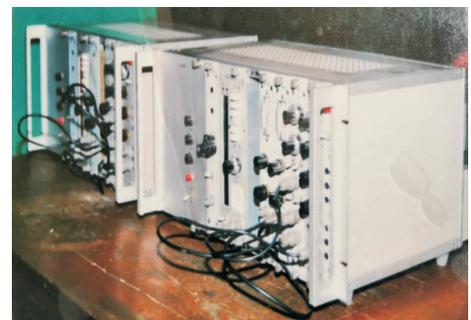
图1 单台FH-1901型单道 $\gamma$ 谱仪和简易型多脉冲延时器“+”
