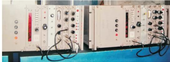
图3 双台 FH-1901 型单道  $\gamma$  谱仪和双台多脉冲延时器“+”
