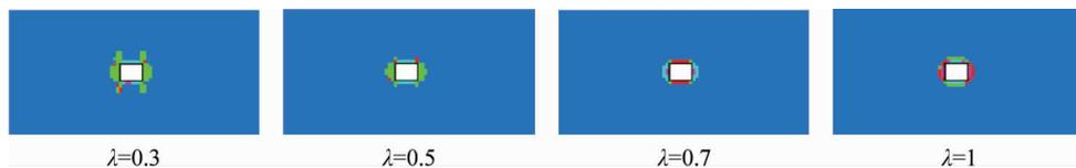
图2 5.0 m×4.0 m的矩形巷道不同 $\lambda$ 时的模拟结果
