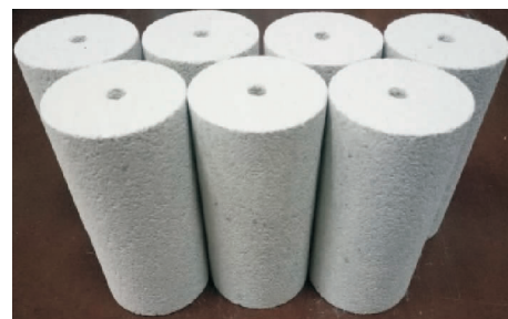
图 1 孔道砂岩岩样
