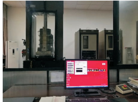
图3 MTS815 岩石力学试验系统
