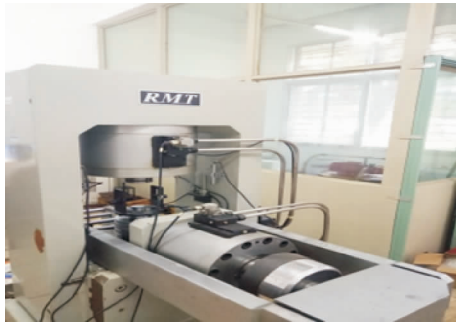
图2 RMT-150 压缩试验机
