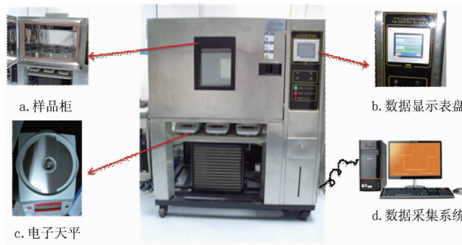
图 1 深部软岩气态水吸附智能测试系统
