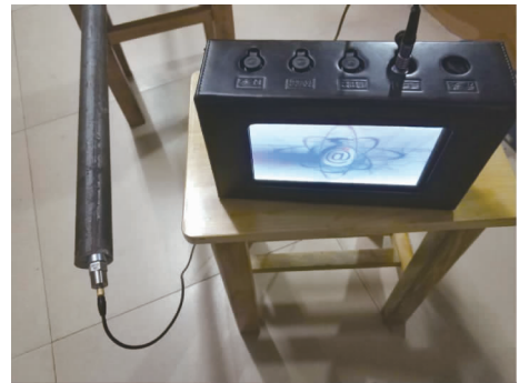
图8 锚杆无损检测
