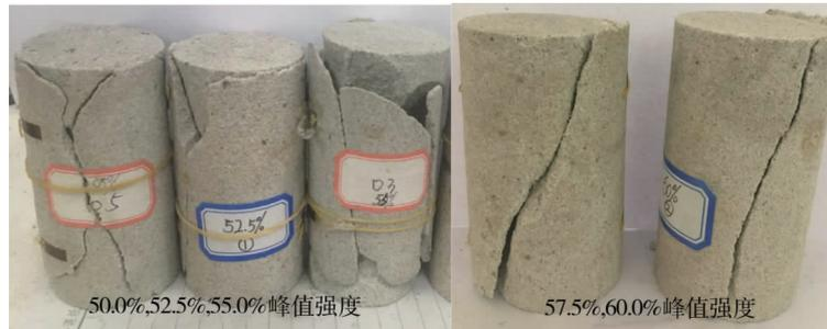
图3 初始损伤试件单轴再加载破坏形态
