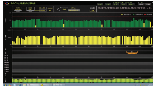
图 5 液压支架电液控操作主界面
