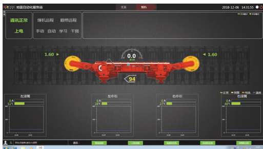
图 4 采煤机自动化控制软件主界面
