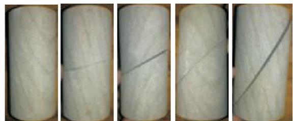
图2 完整试件和含软弱夹层试件
