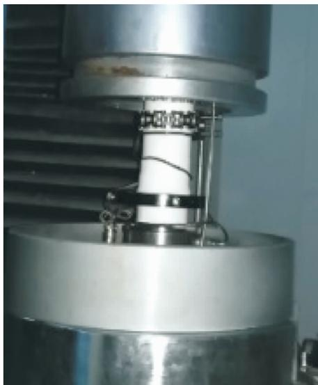
图4 含倾斜软弱夹层砂岩单轴压缩试验
