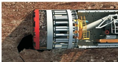
图 10 盾构掘进到岩溶的位置
