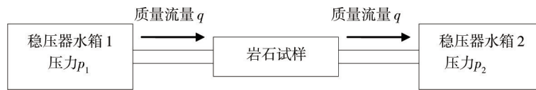
图4 瞬态法试验原理
