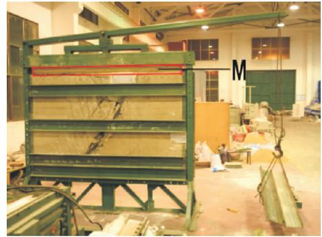
图4 杠杆重力加载装置实物
