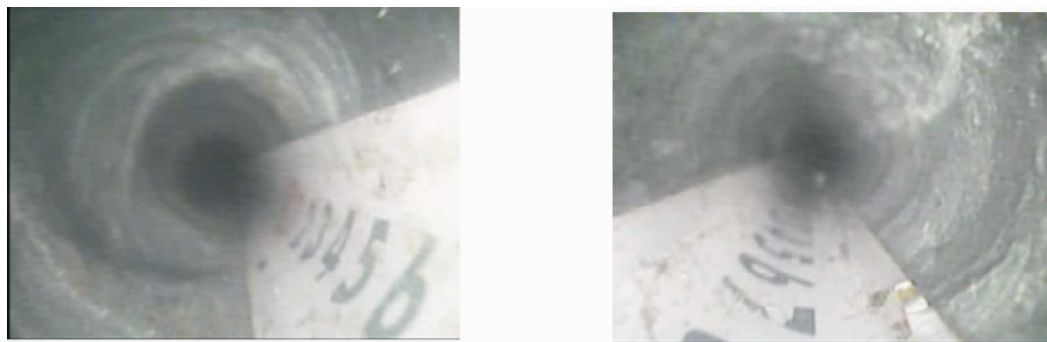
图 11 巷道围岩注浆效果观测
