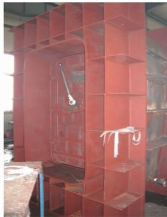
图8 防护门密闭防水试验容器
