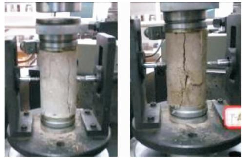
图 4 无锚类岩石试样单轴压缩破坏情况
