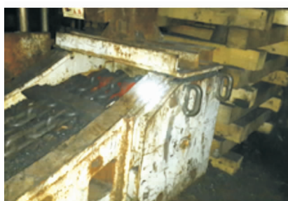
图4 过陷落柱期间大溜简易机尾
