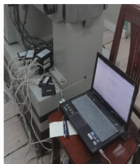
(b) AEwin-USB 声发射检测系统
