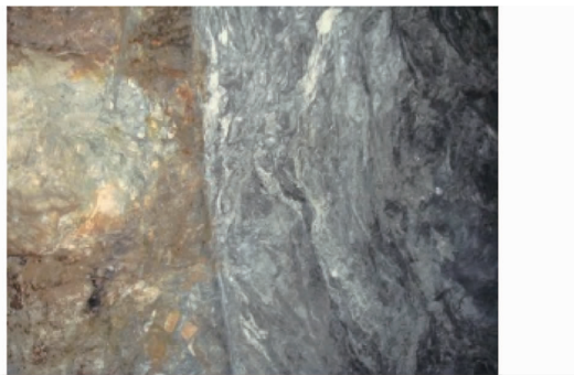
图中左边为断层角砾岩,右边为断层泥
