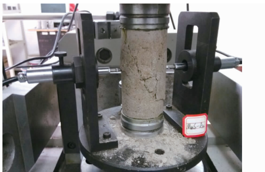
(a) 锚固试样破坏情况
