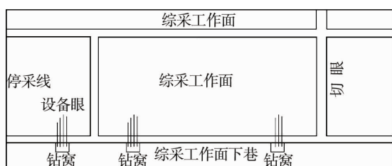
图1 注水试验钻孔布置示意图
