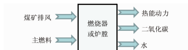
图1 煤矿风排瓦斯作为辅助燃料减排利用技术的基本原理
