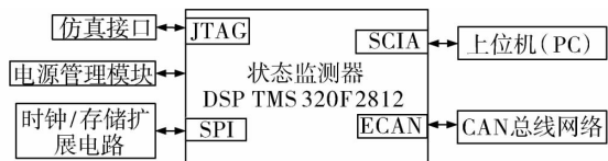
图 2 状态监测器电路框图
