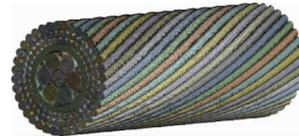
图 5 铠装脐带缆三维网格模型
