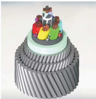
图2 铠装脐带缆三维几何模型
